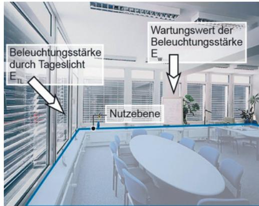
**BILD 6** Zur Definition der relativen Nutzbelichtung (Tageslichtautonomie) zur Bewertung der Tageslichtversorgung in Innenräumen.
